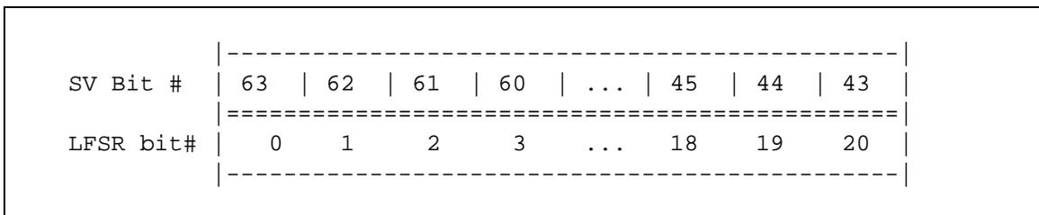
Figure 43: 21-Bit LFSR Format.
