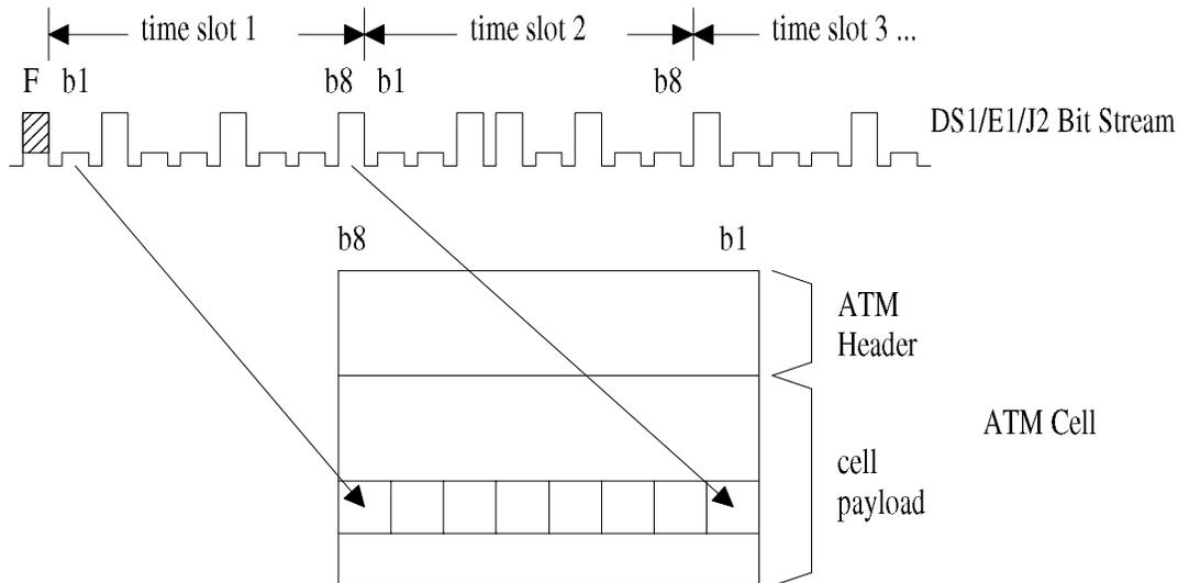
**Figure 2-11: DS1/E1/J2 vs. ATM Bit Ordering**
